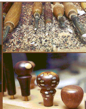
A droite: les différentes gouges (ciseaux à bois) pour dégrossir, façonner, etc. et divers pommeaux prêts à être montés sur fûts de cannes.
